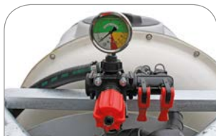
Regolatore di pressione con manometro isometrico
