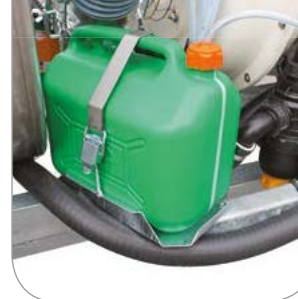
Sistema Dosatron con serbatoio per mescolare i prodotti chimici in linea prima dei getti senza contaminare l'acqua nel serbatoio principale
