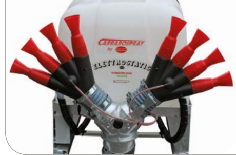
Sistema elettrostatico per caricare la miscela elettricamente quindi viene attirata dalle piante
