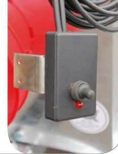
Sistema elettrostatico per caricare la miscela elettricamente quindi viene attirata dalle piante
