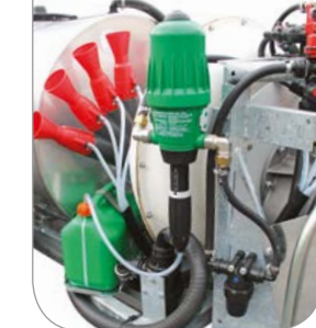
Sistema Dosatron con serbatoio per mescolare i prodotti chimici in linea prima dei getti senza contaminare l'acqua nel serbatoio principale
