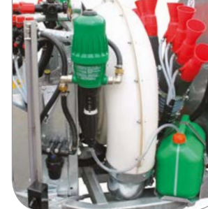
Sistema Dosatron con serbatoio per mescolare i prodotti chimici in linea prima dei getti senza contaminare l'acqua nel serbatoio principale
