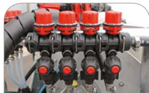
Sistema di calibrazione con piastrine, filtro e getti antigoccia
