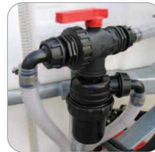
Filtro di aspirazione con valvola di chiusura e saracinesca del circuito lavapianto
