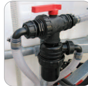
Filtere d'aspiration avec valve de fermeture 3 voies pour circuit de lavage rapide des résidus chimiques
