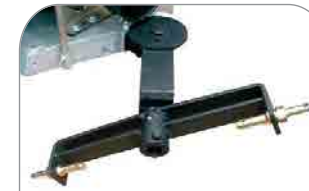
Timone sterzante registrabile fissato ai bracci del sollevamento
