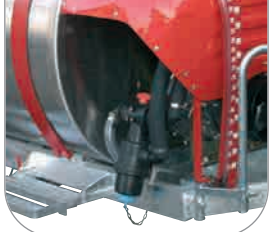
Filtro di aspirazione con valvola di chiusura
