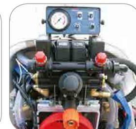
Comando a distanza elettrico mod. ARAG (12 Volts) con regolazione elettrica e manometro in cabina
