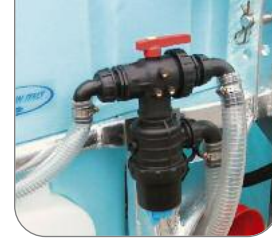
Filtro di aspirazione con valvola di chiusura a saracinesca del circuito lavapianto
