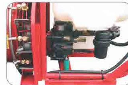
Pompa a membrane e filtro d'aspirazione
