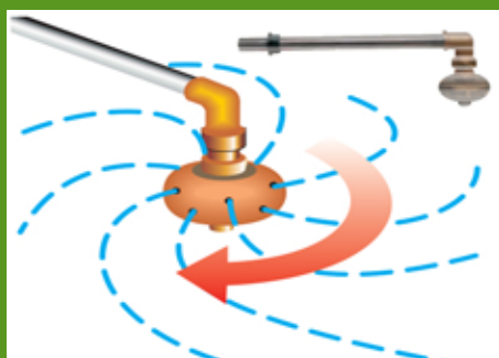
Sistema di lavaggio con getto interno al serbatoio
