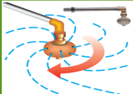
Système de lavage avec jet à l'intérieur du réservoir
